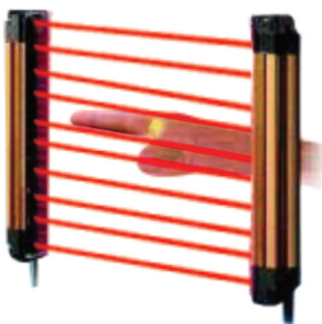
手指检测用最小检测物 体光轴间隔10mm分辨率 Φ17mm
