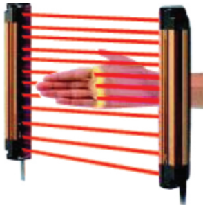
手掌检测用最小检测物 体光轴间隔20mm分辨率 Φ32mm
